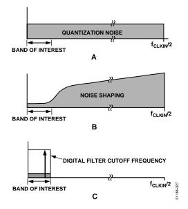
Figure 27. Sigma-Delta ADC
