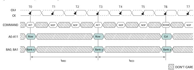
Figure 8: Example: Meeting <sup>t</sup>RCD (<sup>t</sup>RRD) MIN When 2 < <sup>t</sup>RCD (<sup>t</sup>RRD) MIN/<sup>t</sup>CK  $\leq$  3
