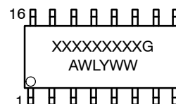
SOIC-16 D SUFFIX CASE 751B
