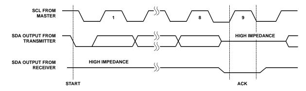
FIGURE 17. ACKNOWLEDGE RESPONSE FROM RECEIVER
