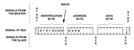
FIGURE 18. BYTE WRITE SEQUENCE
