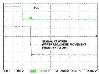
FIGURE 14. LARGE SIGNAL SETTLING TIME
