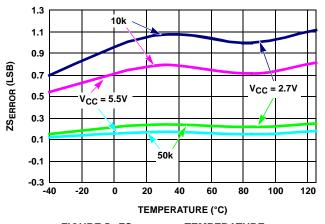
FIGURE 5. ZS<sub>ERROR</sub> vs TEMPERATURE
