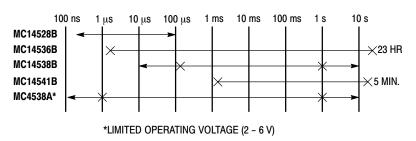
TOTAL OUTPUT PULSE WIDTH RANGE RECOMMENDED PULSE WIDTH RANGE
